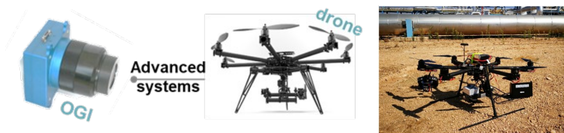
Fig. 2: Sistema dual de detección embarcado en drone
